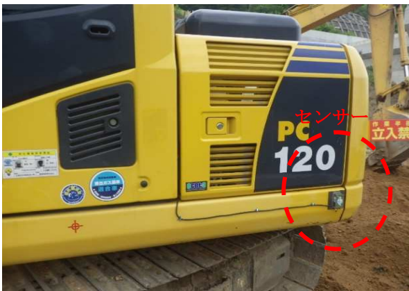
バックホウの後方に設置したセンサー
