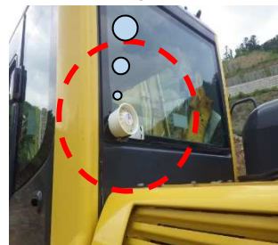
センサーに反応があるとバックホウの運転席と外部に警報
